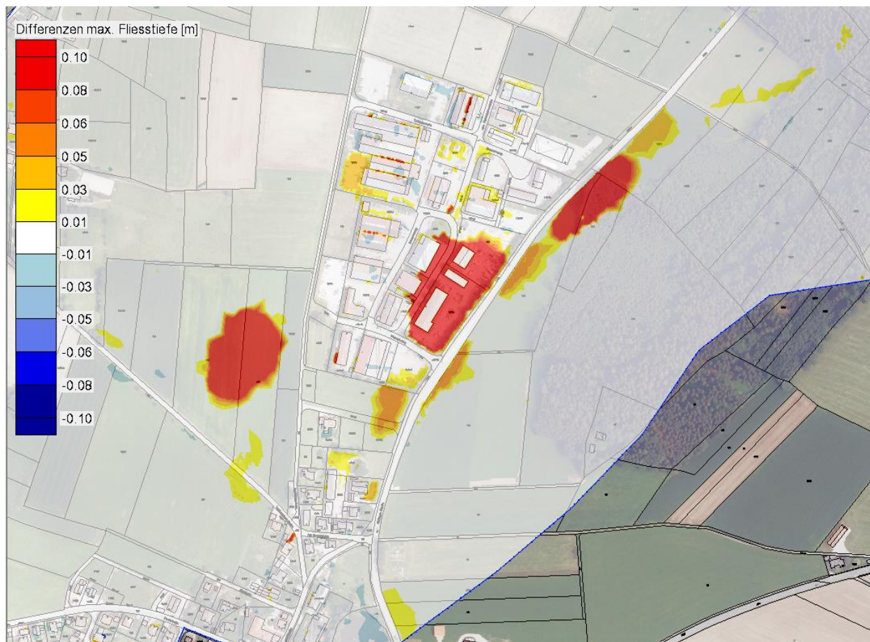
Abbildung 3.6: Differenzen maximale Fließtiefe (60 Minuten – 30 Minuten)
