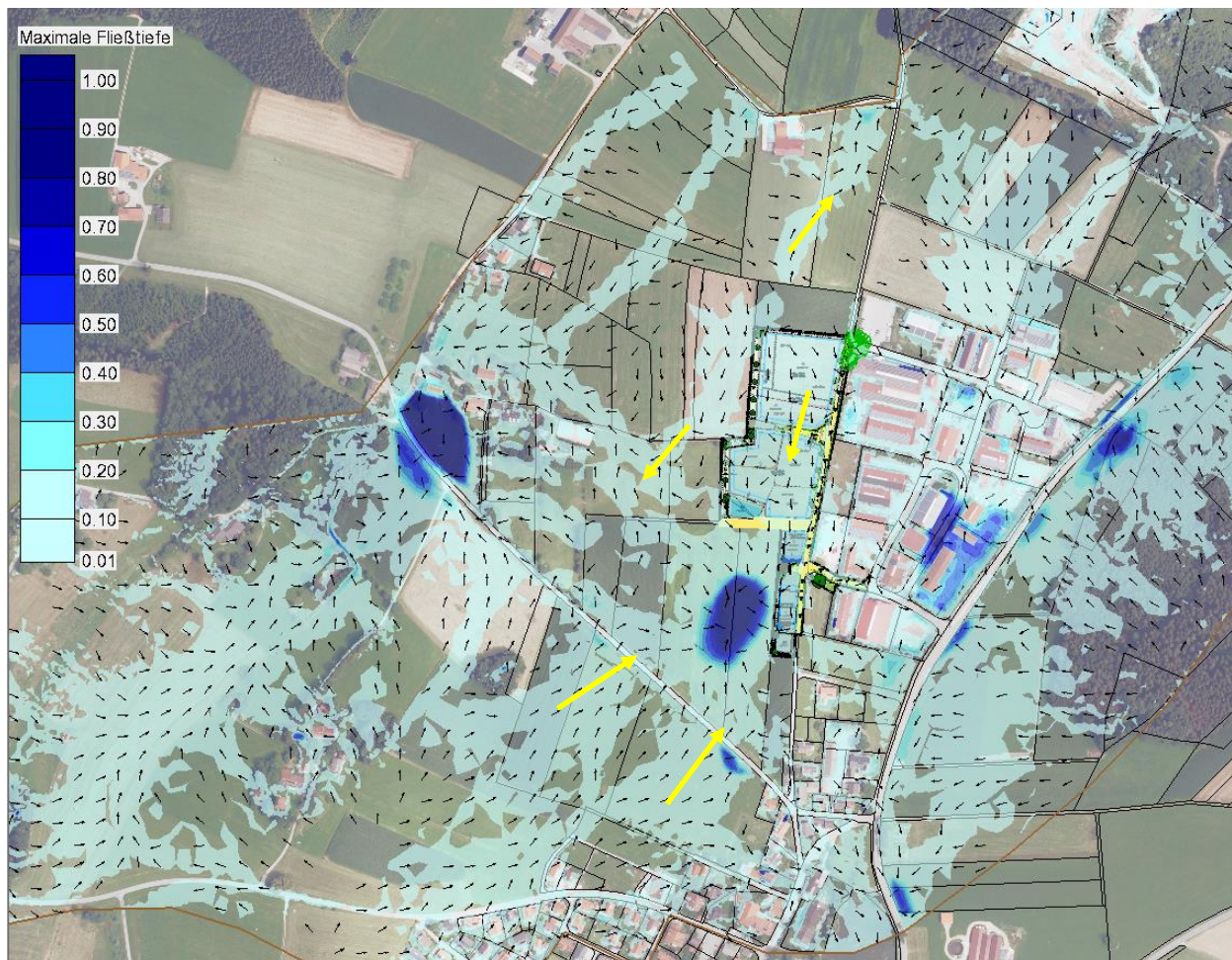
Abbildung 4.6: Maximale Fließtiefen und Strömungsrichtungen; Planungszustand; N100
