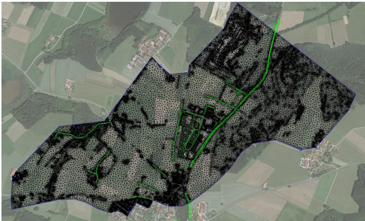
Abbildung 3.1: 2D-Abflussmodell Ist-Zustand mit berücksichtigten Bruchkanten in grün
