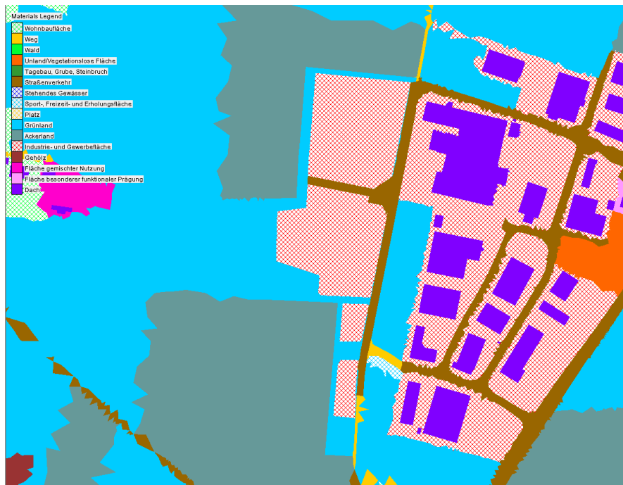
Abbildung 4.4: Materialbelegung im Projektgebiet, Abflussmodell Planungszustand
