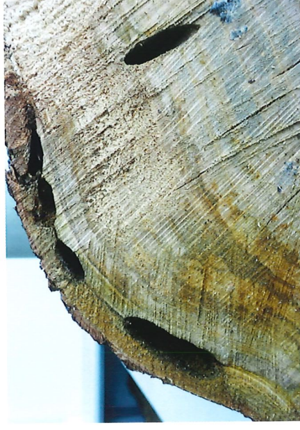
Abb. 5: Bohrgänge im Holz
